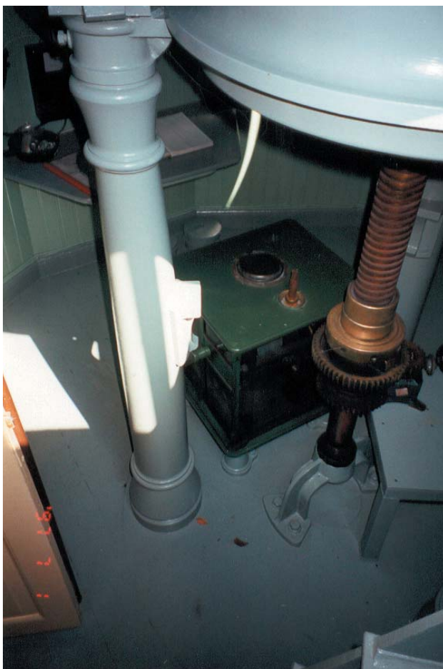
Bild 43 och 44. Närbild av fyrljusets underrede och maskineri efter ommålning.
